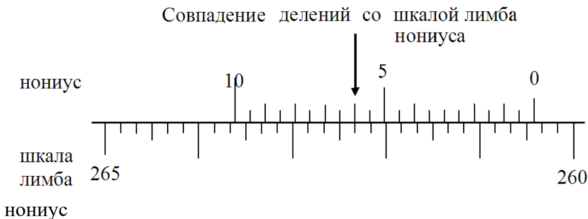
Рис.4.7. Схема отсчета по окуляру.
